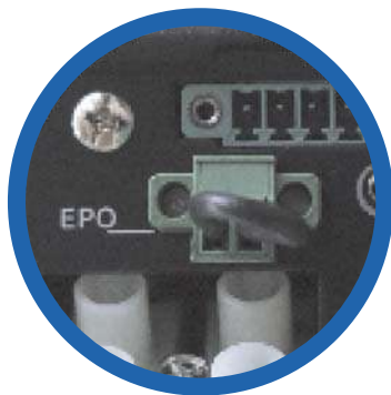
Apagado de Emergencia (EPO)
