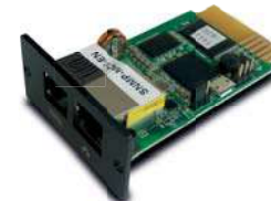
Tarjeta opcional: EMD (Dispositivo de monitoreo ambiental) para que pueda operar se necesita tener la SNMP instalada
