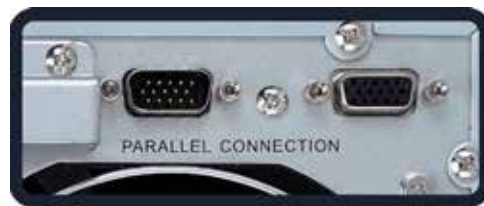
Conexiones a paralelo
