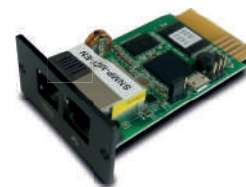
Tarjeta opcional: EMD (Dispositivo de monitoreo ambiental)
